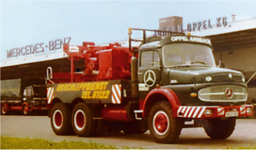
Auch der gehörte dazu: Abschleppwagen LK 2633 mit 6x4-Antrieb. Das 230 PS starke Auto verfügt über 13.750 ccm Hubraum und verkräftet ein zulässiges Gesamtgewicht von 26 Tonnen
