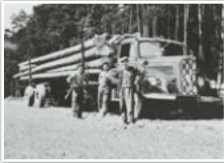
Mercedes L6600: Mit seinem selbstlenkendem Zweiaachs-nachläufer war der Lastwagen eigens für Langholztransporte ausgelegt
