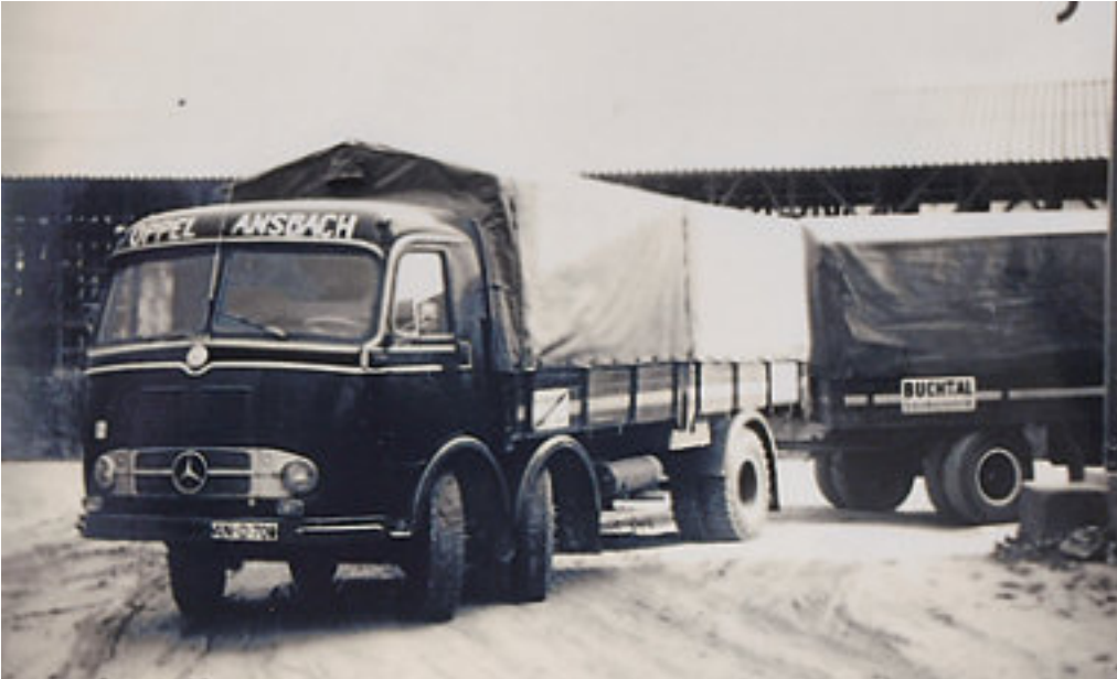
Mit dem „Tausendfüßler“ steigt die Firma Oppel in den Fernverkehr ein. Der LP 333 mit seinen zwei gelenkten Vorderachsen war die Mercedes-Antwort auf die ungeliebte Achslastbeschränkung
